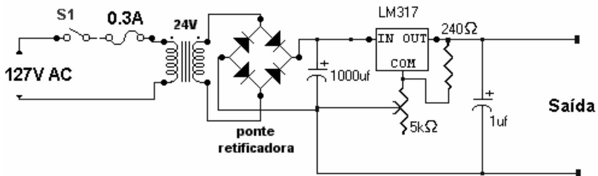
a) Considerando-se que potenciômetro é ajustado para uma tensão de saída de 12V, qual será o valor aproximado da corrente de carga que queima o fusível de 0.3A? (1 ponto)
