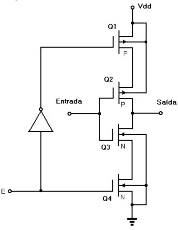
a) Considerando que as entradas podem ser 0V (Nível lógico 0) e 5V (Nível Lógico 1), encontre a função lógica que este circuito implementa, preenchendo a tabela abaixo com **ON** para ligado e **OFF** para desligado (2 pontos):
