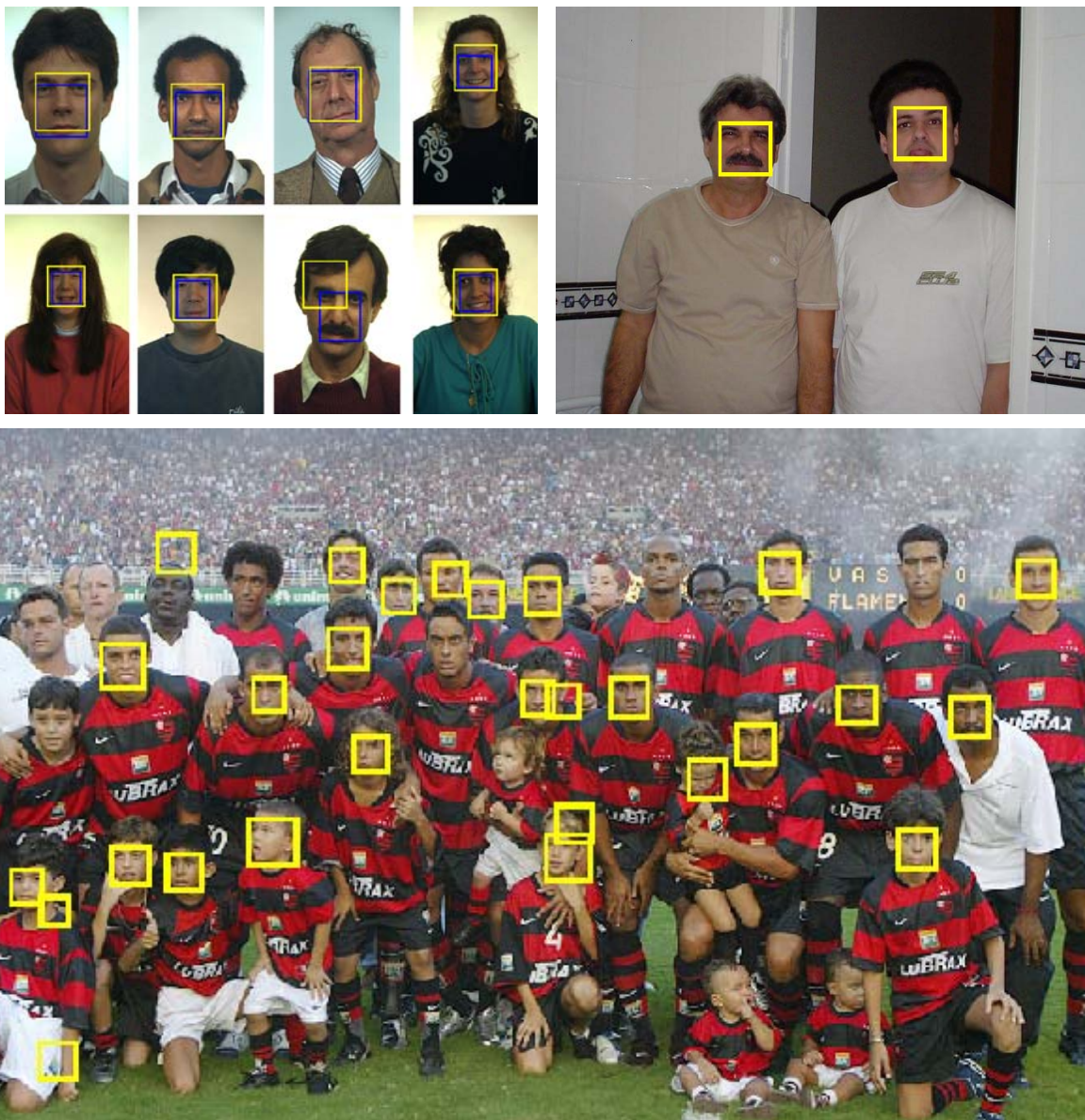
Figura 10 - Testes usando o sistema de detecção de faces. Bancos de dados FERET (esquerda superior, marcações manuais em azul e detectadas pelo sistema em amarelo). Fotografias contendo mais de uma face (direita e abaixo)
