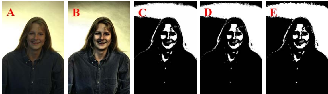
Figura 3 – Teste de detecção de pele - Figura original (A), aplicação de correção de histograma (B), teste de pele em resolução total (C), meia (D) e um quarto de resolução (E).
