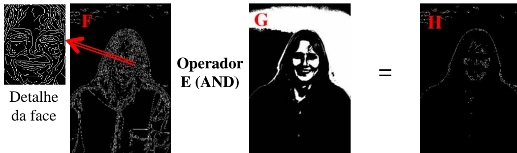
Figura 4 - Aplicação do filtro de bordas (F) com detalhe da face. Filtro de pele (G). Pontos borda-pele (H).
